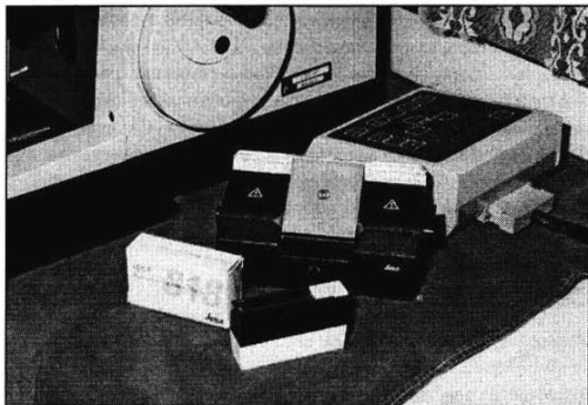
Obr. 2. Samostaný držiak a používané žiletky Leica model 818
